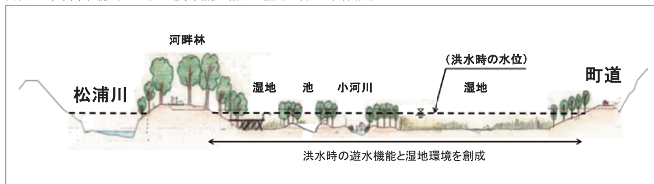
図表3 佐賀県松浦川における遊水機能を備えた湿地の再生(断面図)
