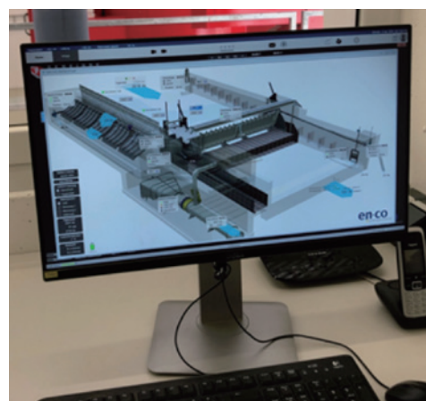
写真3- 取水設備の全自動制御システムモニター
